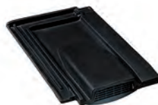
Tuile chatière grillagée (ouverture 34 cm²) 4,3 kg/pièce
