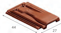
Tuile châtière (ouverture 35 cm 2 ) 3,5 kg/pièce
